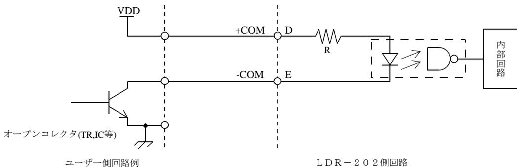
最大定格 印加電圧 (VDD) = DC12 ~ DC24V
