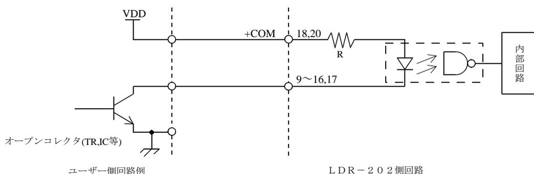
最大定格 印加電圧 (VDD) = DC12 ~ DC24V
