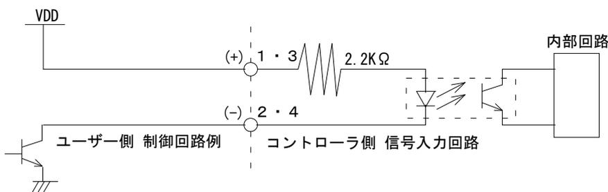
最大定格 印加電圧 (VDD) = DC12V (MIN)
